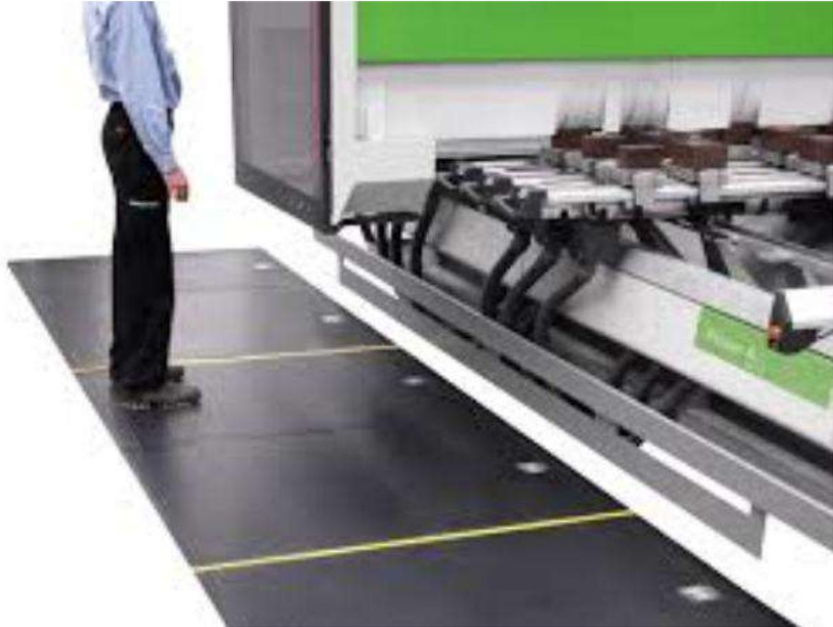
Quando il lavoratore sale sulla pedana si interrompe il funzionamento della macchina
